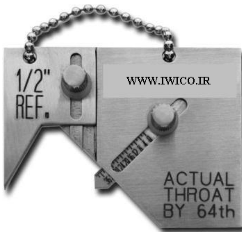
شکل ۳۳ - نمونه‌ای از گیج جوشکاری Mini Sub Socket weld
