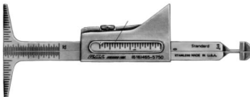
شکل ۱- شمایی از HI-LO WELDING GAGE
