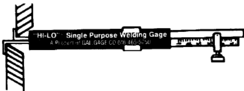
شکل ۴- اندازه‌گیری عدم همترازی و انطباق دیواره داخلی
