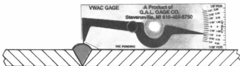
شکل ۱۵- اندازه‌گیری میزان فلز جوش اضافی یا تحذب گرده جوش
