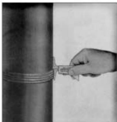
شکل ۲- اندازه‌گیری تحذب گرده جوش
