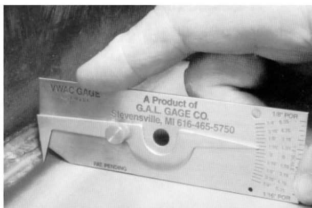
شکل ۱۷- شیوه قرارگیری روی سطوح برای اندازه‌گیری عمق بریدگی کناره جوش
